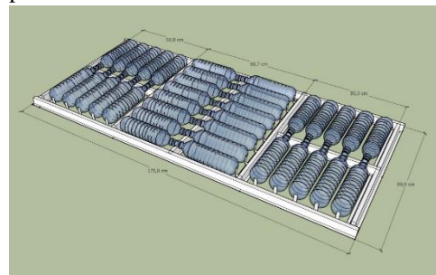
(Hasil Rancangan menggunakan SketchUP 3D, 2022) Gambar 3.1 Rancangan Model Rakit Apung
