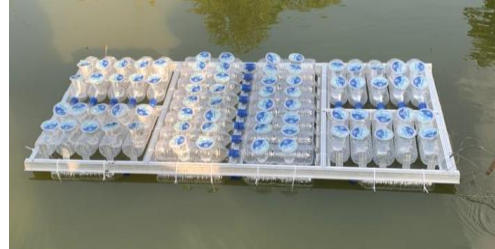
Gambar 4.1 Pengujian pada model rakit (model 1) Dengan pelampung Horizontal (Dokumentasi Pribadi, 2022)
