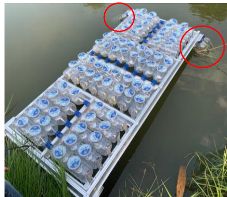
Gambar 4.2 Pengujian pada model rakit (model 1) Dengan pelampung Vertikal (Dokumentasi Pribadi, 2022)
